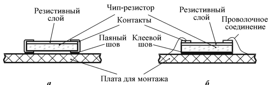
Рис.1. Схематическое изображение чип-резистора, монтируемого на поверхность платы: а – пайкой контактов непосредственно к металлизации платы; б – посадкой на клей на поверхность платы и проволочным соединением контактов с металлизацией платы
