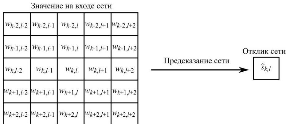
Рис. 3. Входной образ и отклик нейронной сети Fig. 3. Input wavelet coefficients set and response of the neural network
