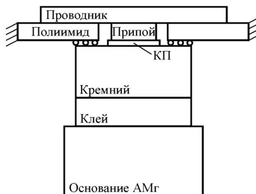
Рис.1. Расчетная схема соединения микроэлектронного модуля
