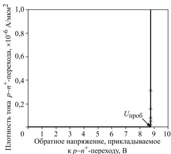
Рис. 3. Обратная ветвь ВАХ p-n^+ -перехода, полученной при моделировании в прямоугольной системе координат
