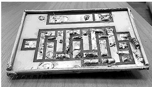
Рис. 6. Печатная плата широкополосного усилителя Fig. 6. Wideband amplifier circuit board
