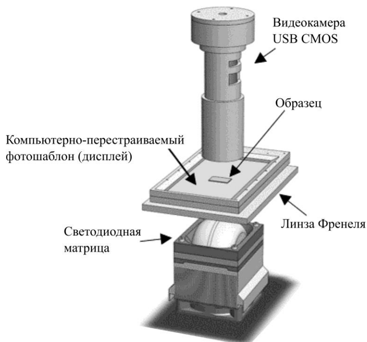
Рис. 2. Общий вид станда для экспонирования рисунка Fig. 2. General view of the stand for exposing the picture
