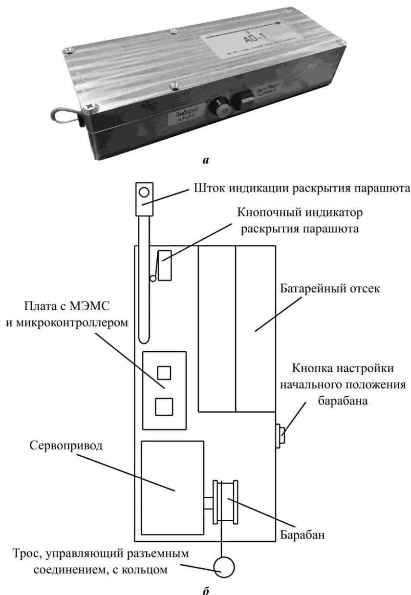
Рис. 5. Общий вид (а) и схема (б) разработанного устройства автоотцепки Fig. 5. General view (a) and scheme (b) of the final version of the automatic uncoupling
