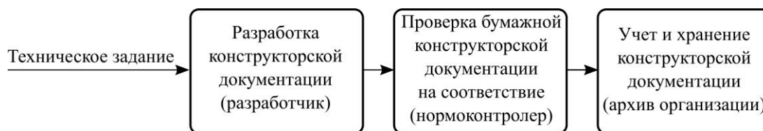
Рис. 1. Модель традиционного проведения нормоконтроля Fig. 1. Traditional regulatory document control model
