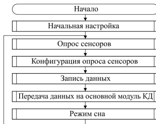
Рис. 5. Алгоритм работы подключаемого модуля концентратора данных измерительного поста АСМОС
