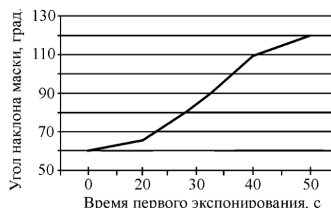
Рис.3. Зависимость угла наклона маски фоторезиста к плоскости пластины от времени экспонирования первого слоя
