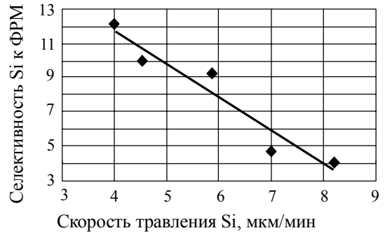
Рис.2. Зависимость селективности травления Si к фоторезисту от скорости травления
