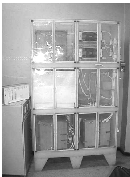
Рис.2. Внешний вид репроцессорного комплекса РК-II для проведения безотходных химических процессов ЖХС фоторезистивных слоев
