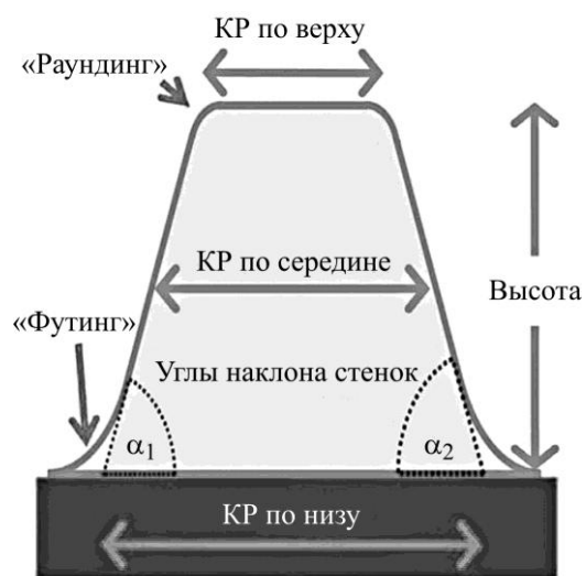
Рис. 2. Типичная структура элемента линии фоторезистивной маски и ее геометрические параметры: КР – критический размер (в данном случае ширина линии); «футинг» – закругление угла по низу; «раундинг» – закругление угла по верху [7]
