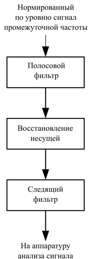
Рис. 8. Обобщенная схема обработки сигнала восстановленной несущей Fig. 8. Generalized scheme of signal processing of the restored carrier
