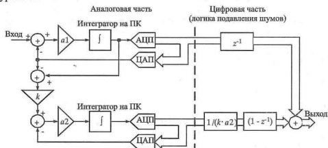
Рис.1. Структурная схема модулятора архитектуры 1-1
