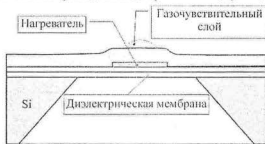
Рис.1. Поперечное сечение структуры ДВОГ
