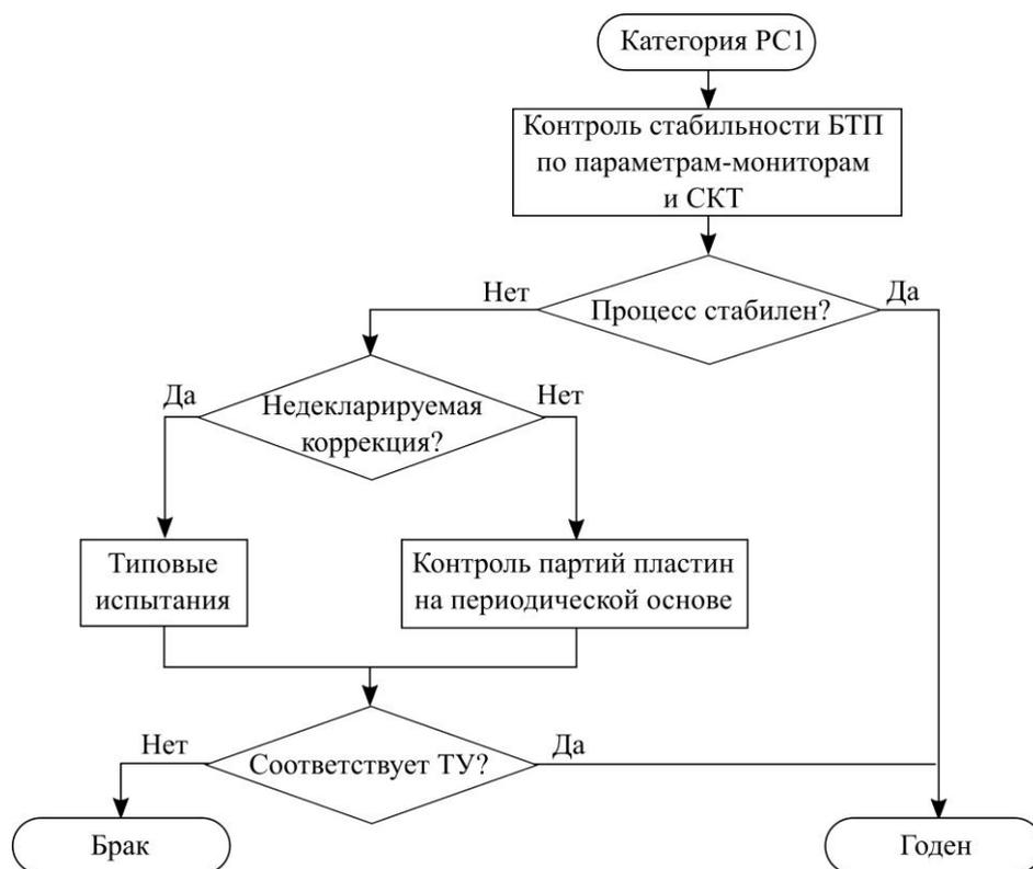
Рис. 1. Блок-схема контроля РС изделий категории РС1
