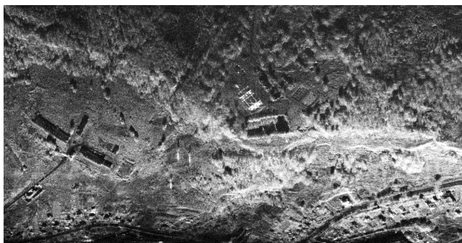
Рис.4. Амплитудное РЛИ после автоподбора параметров с первым приближением V_0
