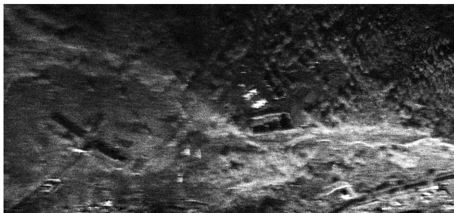
Рис.3. Амплитудное РЛИ, синтезированное с произвольной скоростью V_0
