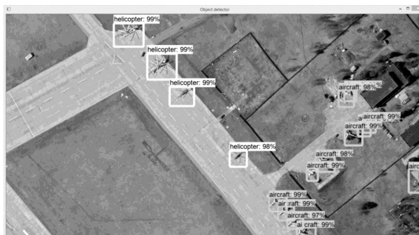
Рис. 1. Результат обнаружения и классификации объектов на фотоснимке Fig. 1. The result of the detection and classification of objects in the photograph
