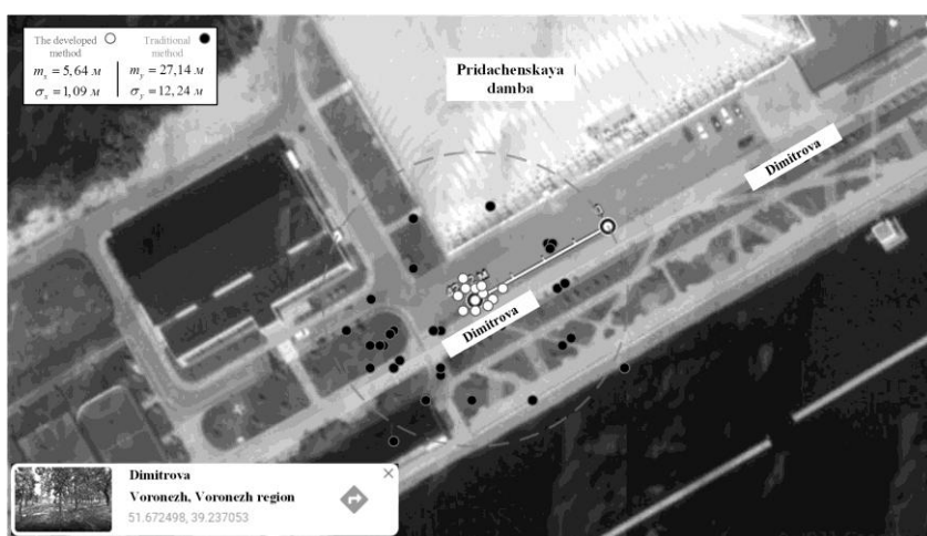
Рис. 7. Оценка расчета географических координат несколькими способами (традиционным – черные кружки; разработанным – белые кружки)
