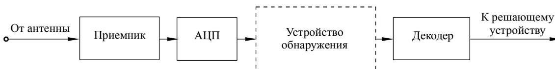
Рис.1. Типовая блок-схема тракта обработки командно-информационного сигнала
