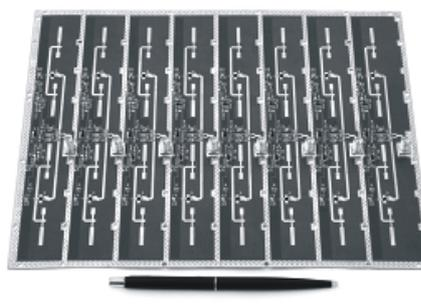
Рис. 7. Активная схема суммирования излучателей АФАР
